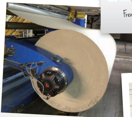
Freno Extreme su svolgitore Extreme brake on unwinder
